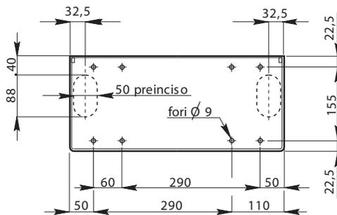
Particolare foratura per viti di sostegno
