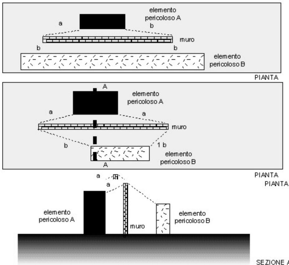
Esempio di distanza misurata con metodo del filo teso fra due elementi pericolosi: la somma delle distanze "a" e "b" è considerata come distanza minima fra gli elementi qualora il muro possieda requisiti specifici (i disegni non sono in scala)
